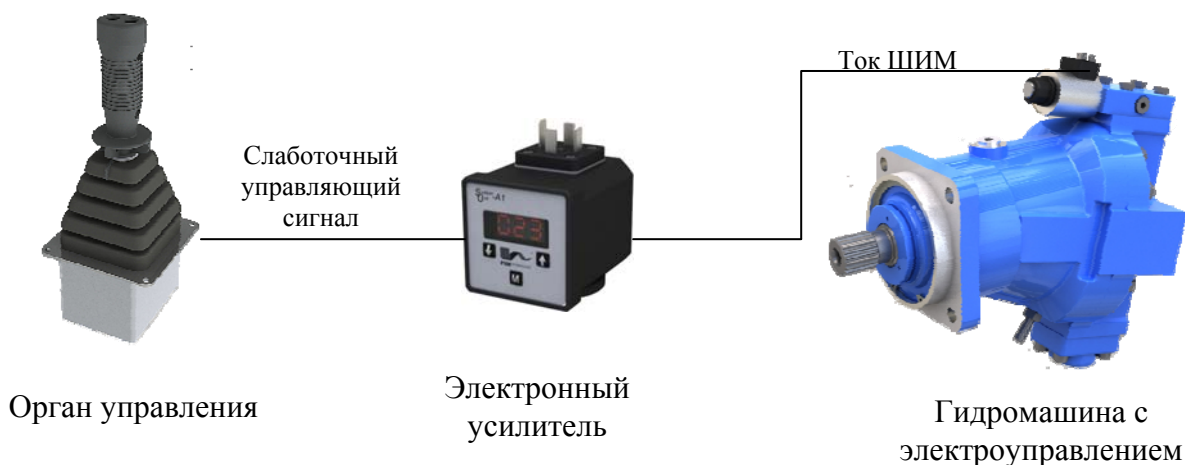
Рис.1 Цепь электроуправления.
